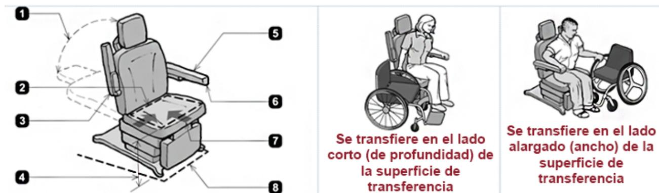
1. Cuando es ajustable, proporciona apoyo de la cabeza y la espalda proporcionado a lo largo de toda la gama de la inclinación (M302.3.3)
